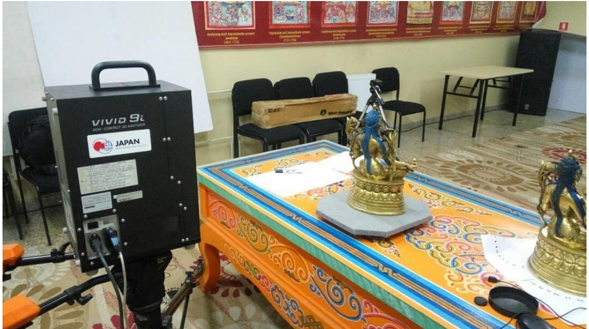
Гурван хэмжээст лазер сканнер хийж буй ажлийн явц
